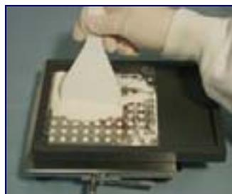
10. Verwenden Sie den Pulver-Verteiler, um das Pulver so zu verteilen, dass es in die Kapselkörper fällt. Schieben Sie das überflüssige Pulver in den Vorratsbehälter.
