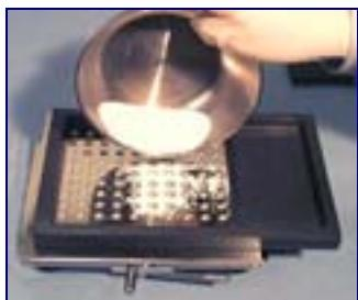
9. Platzieren Sie den Pulver-Einsatzboden in den Einfüller mit Hilfe der Positionierstifte und gießen Sie das Vorgemessene Pulver ein.
