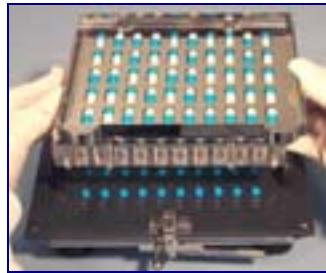
6. Um die restlichen Reihen zu füllen, wiederholen Sie die Schritte 1-4, nur diesmal kommen die Orientier-Positionierfüße in die Fülllöcher mit der Markierung "II".
