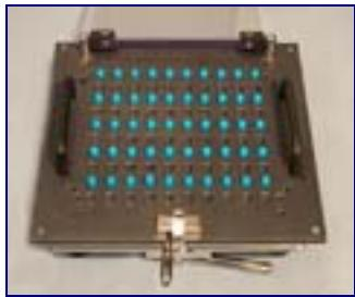
5. Orienter entfernen. Die Kapseln befinden sich in jeder zweiten Reihe des Einfüllers.
